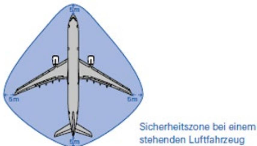
**Abbildung 3:** Sicherheitszone um abgestelltes Luftfahrzeug beträgt **5 Meter**.
