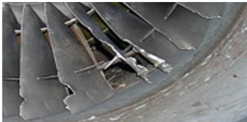
Triebwerksschaden durch FOD!
