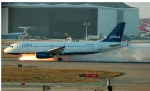
Reifen Platzer bei Landung. Grund: Beschädigung des Reifens durch FOD!
