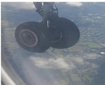
Reifen Platzer nach dem Start durch FOD!
