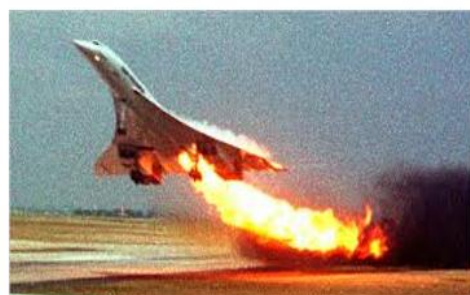
Unglücksflug der Concorde 25. Juli 2000 durch FOD auf der S/L- Bahn. Alle Insassen sterben, dazu noch 4 am Boden!
