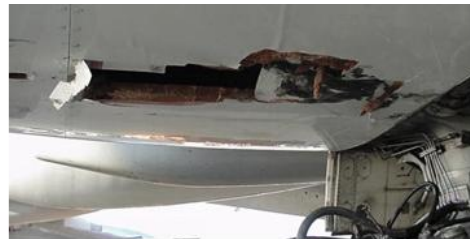
Reifenteile durchschlagen den Rumpf nach Reifen Platzer durch FOD!
