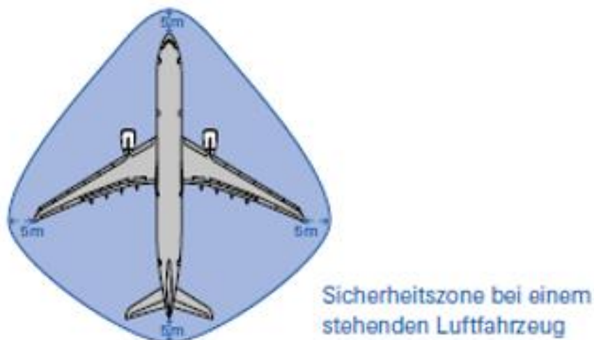
Abbildung 3: Sicherheitszone um abgestelltes Luftfahrzeug beträgt 5 Meter .
